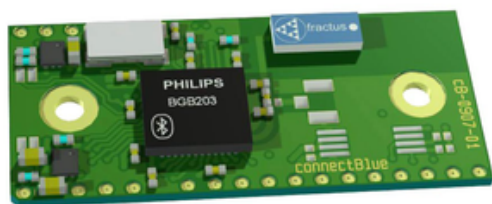
Obrázek 1 – Bluetooth modul OEMSPA310 o rozměrech 36x16 mm
